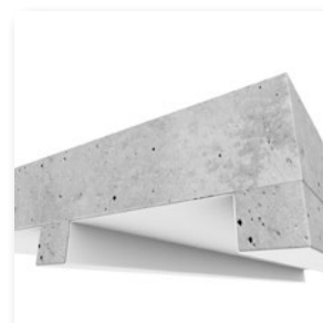
In-situ støbte betondæk og betonbjælker
